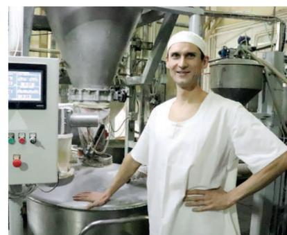
силосы. Оттуда по пневмотрассе оператор направляет муку на весы и далее распределяет ее по четырнадцати бункерам. И уже из бункеров мука нужного сорта дозируется в дежи – такие большие чаши для замешивания теста.
