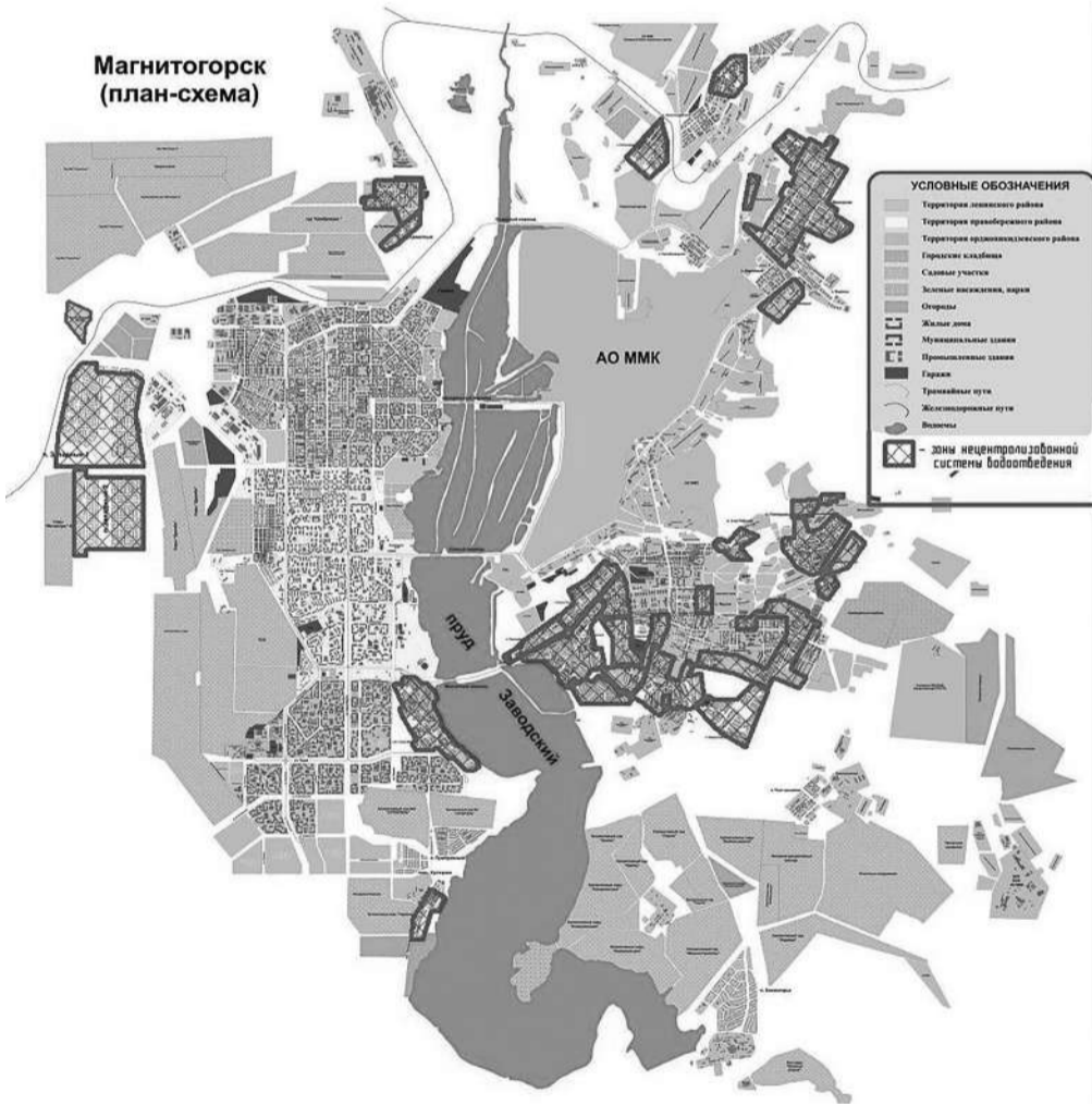
Рисунок 45 – Зоны нецентрализованной системы водоотведения
