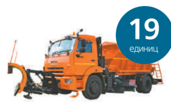
КДМ – комбинированные дорожные машины на базе КАМАЗ, оборудованные передним поворотным отвалом, щеткой, бункером для противогололедных материалов, электронной автоматической системой дозирования материалов
