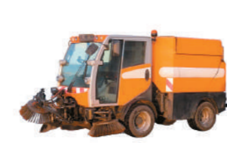
Подметально-уборочные машины CityCat 2020 со снежным отвалом и бункером для инертных материалов
